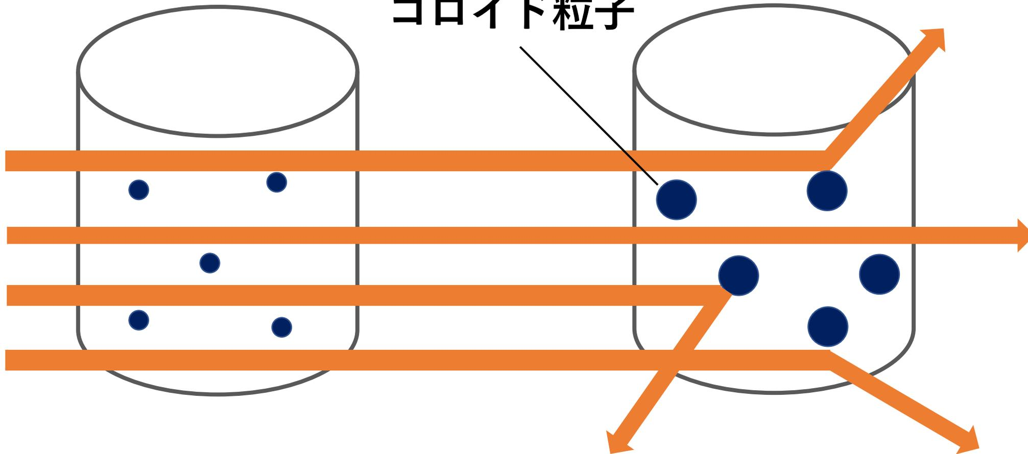
コロイド粒子は光を散乱させるので、コロイド溶液中を通る光の道筋が見えます(チンダル現象)
